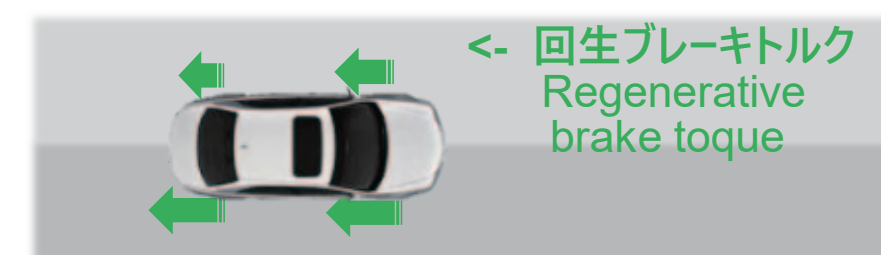
車両構成に応じ、4輪独立回生まで対応可能 Realize 4 wheel regen control depends on vehicle architecture
